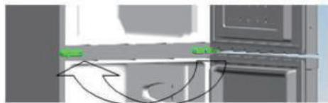
8) Așezați ușa în poziția corectă, fixați balama din mijloc.
