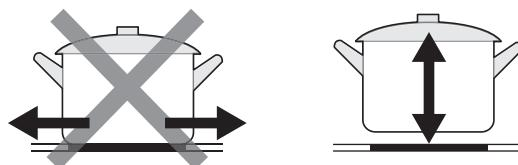
Các vùng nấu, ở mức nhất định, sẽ tự động điều chỉnh cho phù hợp với đường kính của dụng cụ nấu ăn. Tuy nhiên đáy dụng cụ nấu ăn phải có đường kính tối thiểu theo vùng nấu tương ứng. Để bếp đạt được hiệu quả tốt nhất, vui lòng đặt dụng cụ nấu ăn ở giữa vùng nấu.
